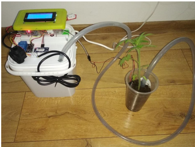
Obr. 5 Automatický zavlažovací systém
