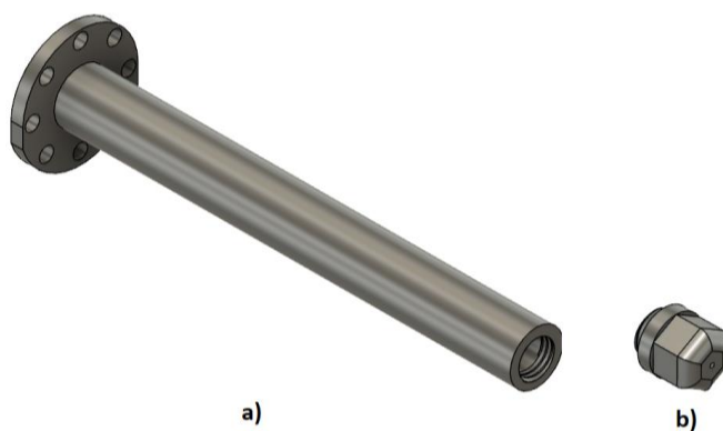
Obr. 9 3D model: a) výhrevná komora, b) tryska
