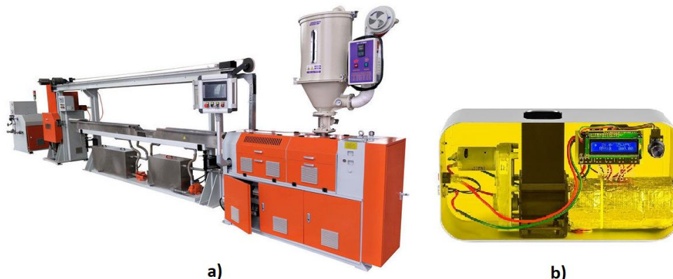
Obr. 1 a) Profesionálna výrobná linka, b) kompaktné zariadenie na výrobu struny pre domáce použitie [3][4]
